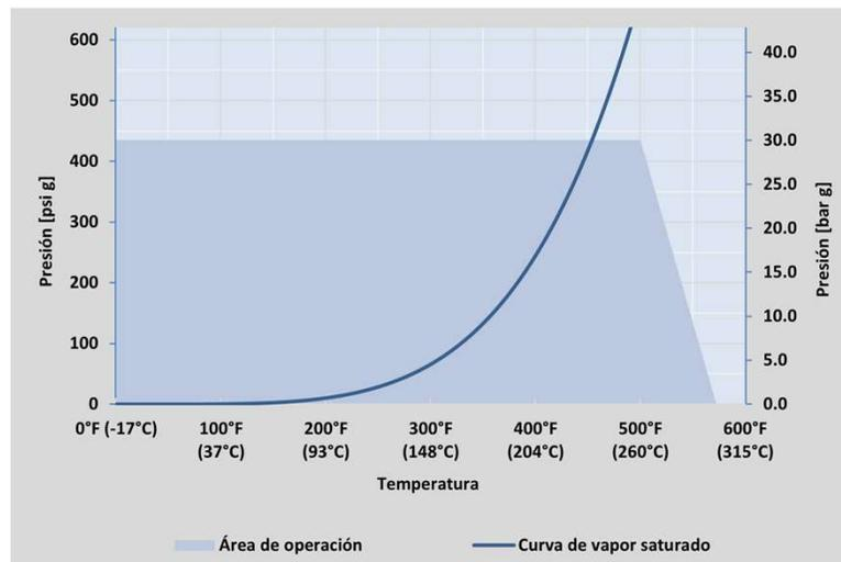
\* Las aplicaciones de proceso incluyen intercambiadores de coraza y tubo, calentador de aire, calorificador, marmitas, etc. Las trampas están diseñadas para trabajar el rango completo de la aplicación por ejemplo mínimo y máximo flujo.
